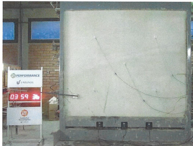
Figura 4 – Realização do teste de estanqueidade aos 239 minutos
